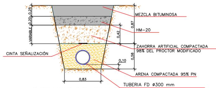
**DETALLE DE ZANJA BAJO CALZADA**
